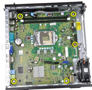
14. システム基板から 7 mm 六角ネジを取り外します。
