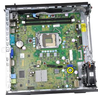
15. システム基板をコンピュータの前面に向かってスライドさせます。
