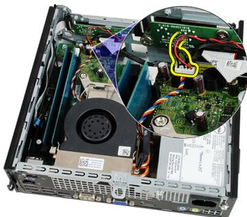
6. スピーカーケーブルをシステムファンケーブルと WLAN (ワイヤレスローカルエリアネットワーク) アンテナ (装着されている場合) の下から引き抜きます。
