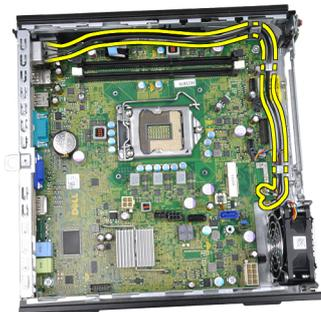
13. システム基板をシャーシに固定しているネジを外します。
