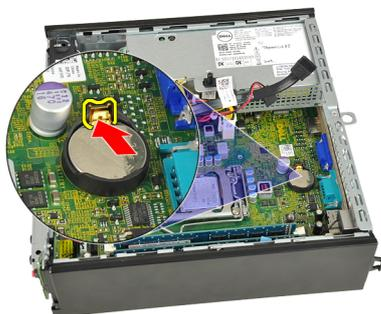
7. コイン型電池をコンピューターから取り出し、電池を適切に処分します。
