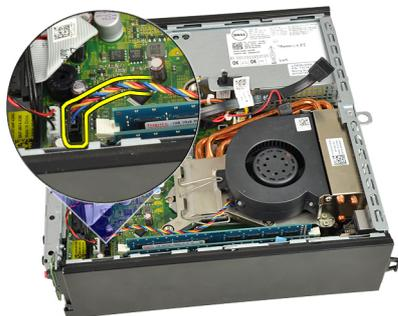
6. リリース レバーを押し下げ、外側に動かしてファン固定フックを解除します。
