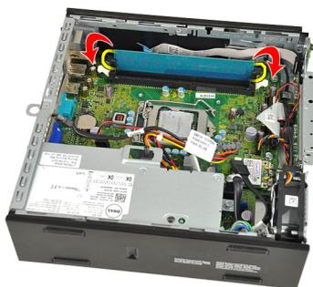
6. メモリモジュールを持ち上げながら、システム基板のコンネクターから取り外します。
