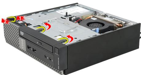
4. ベゼルを回しながらコンピューターから取り出し、シャーシから逆のベゼルの端のフックを解除します。
