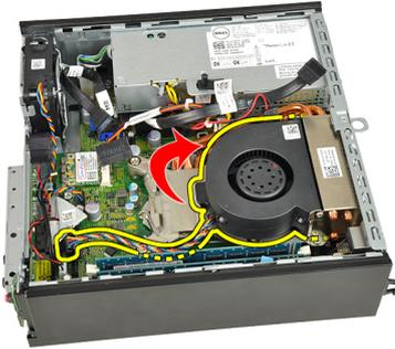
8. ヒートシンク/ファンアセンブリをシステム基板に固定している拘束ネジを緩めます。
