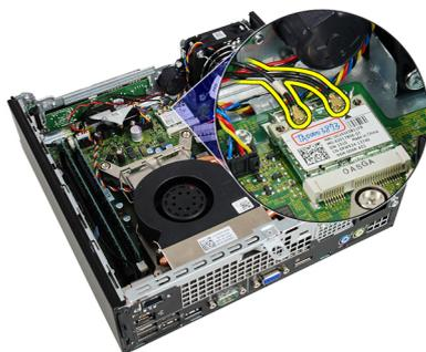
6. 固定レバーを押して WLAN カードから離します。
