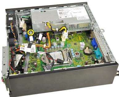
9. 電源ユニットをシャーシに固定しているネジを外します。
