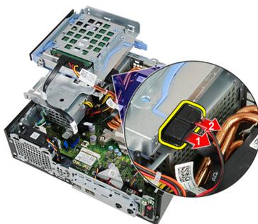
6. データケーブルと電源ケーブルをハードドライブの背面から取り外します。
