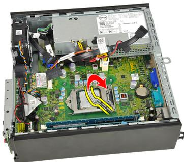
8. プロセッサーを持ち上げてソケットから取り出し、静電防止パッケージに入れます。
