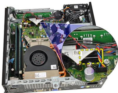
6. 入力/出力ブラケットを固定するネジを外します。
